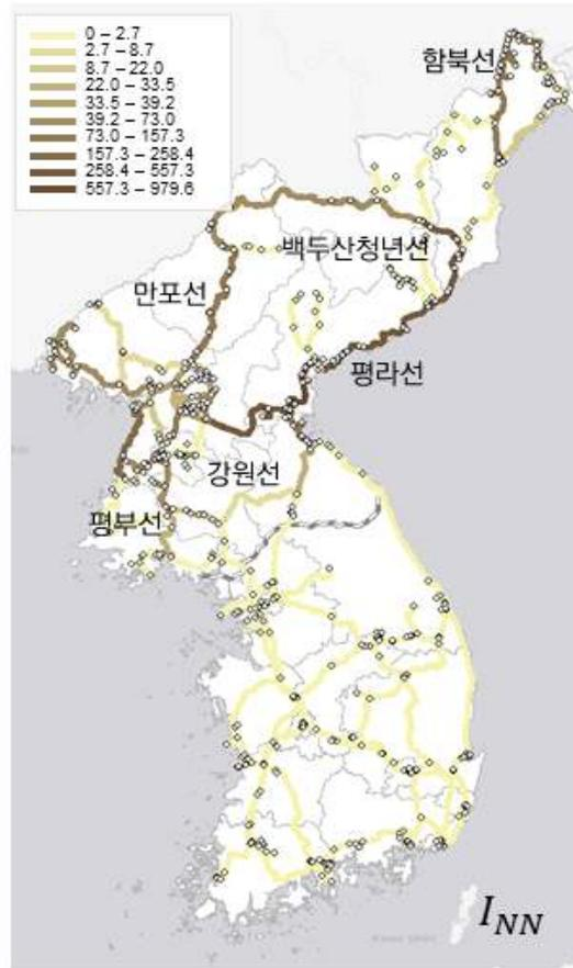
남북한 연결노선인 경의선, 경원선, 동해선의 통행수요가 반영된 링크 치명도  $I_{ALL}$ ,  $I_{sn}$ ,  $I_{ss}$ ,  $I_{nn}$  는 다음과 같다.  $I_{ALL}$ 과  $I_{sn}$  기준으로 경의선, 경원선, 동해선 순으로 치명도가 높으며 이 결과는 통행수요가 반영되지 않은 링크 치명도에서의 순서와 같다. 또한 세 노선은 남북한 연결노선 특성상  $I_{ALL}$ 보다  $I_{sn}$ 이 더 크다. 세 노선의  $I_{ss}$ 는 모두 0으로 나타난다.  $I_{nn}$ 에서 경의선과 경원선의 값이 0이 아닌 이유는 북한에 위치한 두 정류장인 성산역, 개풍역간 최단경로가 남북한 연결노선인 경의선과 경원선을 통과하기 때문이다.
