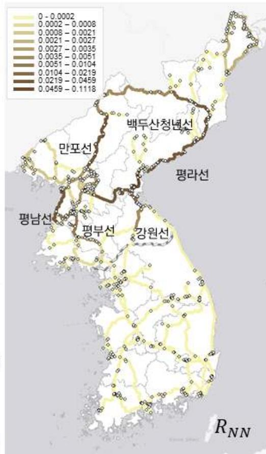
남북한 연결노선인 경의선, 경원선, 동해선의 연결 신뢰성  $R_{ALL}$ ,  $R_{sn}$ ,  $R_{ss}$ ,  $R_{nn}$  는 다음과 같다.  $R_{ALL}$ ,  $R_{sn}$  기준으로 경의선, 경원선, 동해선 순으로 값이 크며, 이 결과는 남북한 통합 철도망의 연결성 측면에서 경의선이 동해선보다 더 중요한 것을 의미한다. 또한 세 노선은 남북한 연결노선 특성상  $R_{ALL}$ 보다  $R_{sn}$ 이 더 크고,  $R_{ss}$ 과  $R_{nn}$ 는 모두 0으로 나타난다.
