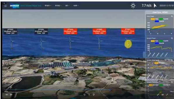
[그림 2-20] 두산중공업이 해상 풍력발전의 실재 모습을 한국MS '디지털 트윈' 기술을 적용해 가상환경으로 구현, 모니터링하는 화면. (출처 : 한국 MS)
