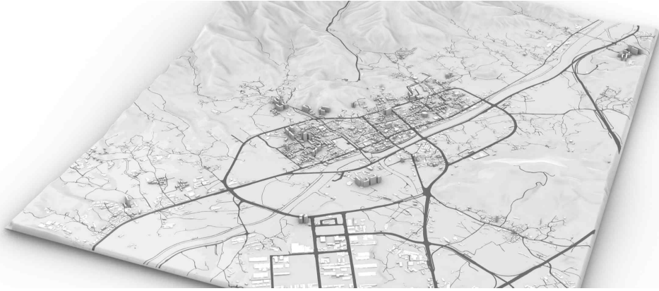
[그림 3-10] Rhino를 통한 건축물 현황 모델 구축 예시 (출처: 연구진)
