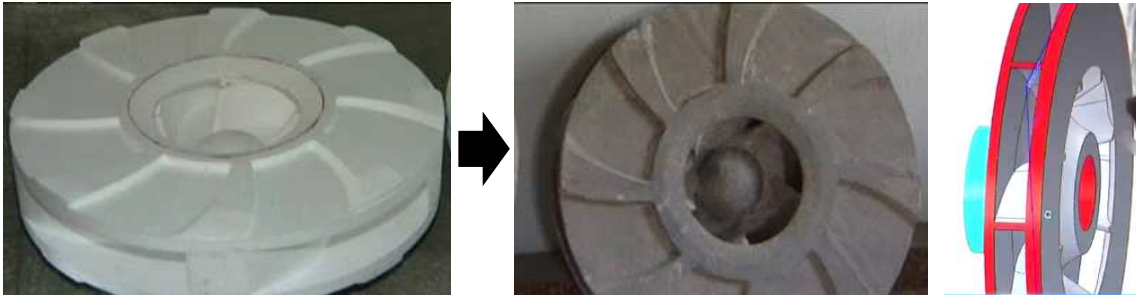
<그림 7> 연소모형주조기술. 왼쪽부터 스티로폼을 깎아 만든 모형, 이를 이용하여 만든 주물 제품, 모형 제작을 위한 컴퓨터 프로그램 화면
