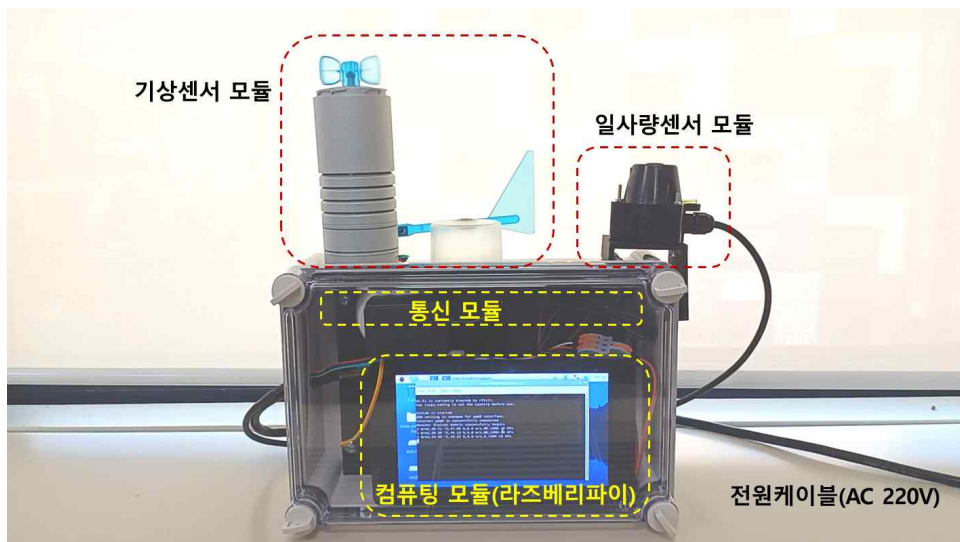
[그림 23] 개발된 기상 연계 태양광 발전 모니터링 시스템
